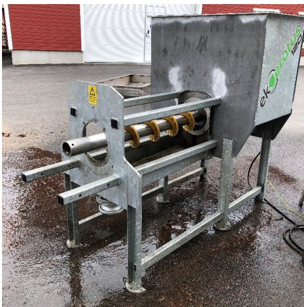
Kuvio 11. Patentoitu ruuvikumi ruuvikuljettimessa
