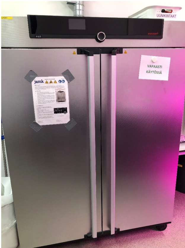
Kuvio 17. Memmert näytekuivuri, jossa näytteet kuivattiin
