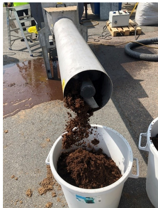
Kuvio 10. Separoitua, valmista massaa tulee ulos separaattorista
