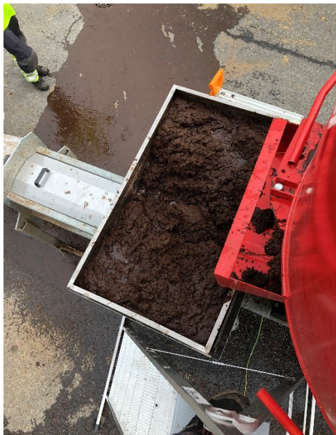
Kuvio 7. Separaattorin täyttösiilo, jonne separoitava materiaali
