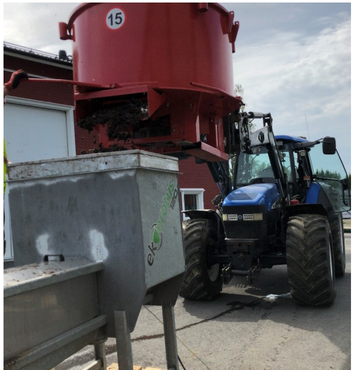
Kuvio 14. Traktorin etukuormaimessa sekoitin, jolla rahkasammal ja vesi sekoitettiin
