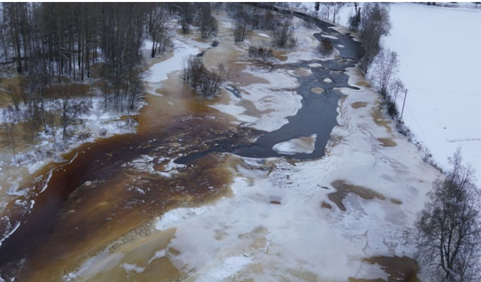
Jokiin muodostuvat hydyetulvat ovat seurausta joen suuresta virtaamasta ja pakkasesta. Kun virtaama on suuri, ei joen pinnalle pääse kehittymään suojaavaa jääkantta. Tällöin vesi voi kylmän sään vaikutuksesta alijäähtyä ja muodostua suppojääksi. Suppojää voi kasautua pohjakiviin, siltoihin, voimalaitosten rakenteisiin tai jokea paikoin peittävän jääkannen alle. KUVA: KATRIINA KETO
