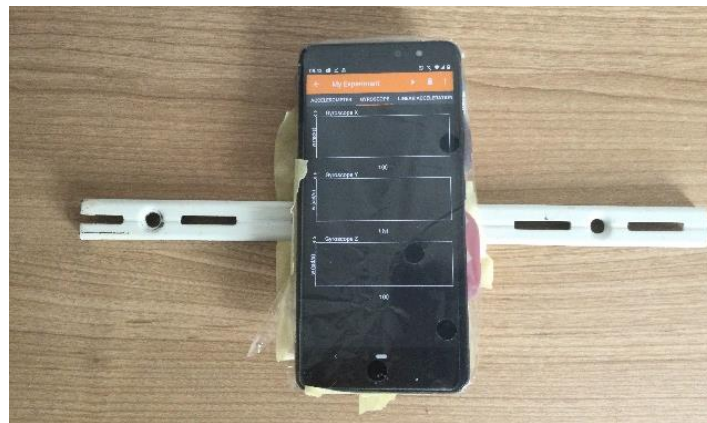
Kuva 4: Liittämällä älypuhelimeen sen x-akselin suuntainen metallikappale kuvan mukaisesti, sen pyörimisominaisuuksia voidaan muuttaa. Pyöriminen x-akselin suhteen on esitetty ylärivissä vasemmalla. Pyöriminen on nyt vakaata toisin kuin kuvan 1 tilanteessa. Pyöriminen y-akselin suhteen on esitetty ylärivissä oikealla. Pyöriminen on nyt epävakaata toisin kuin kuvan 2 tilanteessa. Pyöriminen z-akselin suhteen on esitetty keskirivissä vasemmalla. Verrattaessa kuvaan 3 huomataan, että metallikappaleella ei ole vaikutusta tämän akselin suhteen pyörimiseen, vaan se on vakaata sekä kappaleen kanssa että ilman. Pyörimismäärä x- ja y-akselin suhteen on esitetty keskirivissä oikealla. Dataan tehtiin suoran L(t) = m \cdot t + c sovitus ajanjaksolle [a, b] , jossa pyöriminen tapahtui. Sovituksesta voidaan määrittää L_{\text{start}} = L(a) \Delta = L(a) - L(b) . Mo-lemmissa tapauksissa havaitaan pieni lasku: noin 11 % pyörimismäärässä x-akselin suhteen ja 14 % pyörimismäärässä y-akselin suhteen. Lasku johtuu ilmanvastuksen vaikutuksesta.
