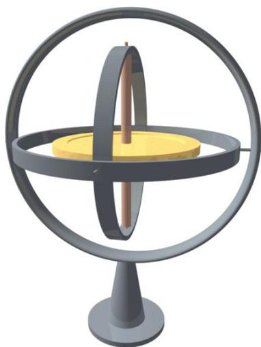
Abbildung 1: Aufbau eines Gyroskops.
