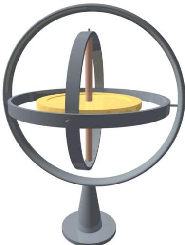
Abbildung 1: Aufbau eines Gyroskops
