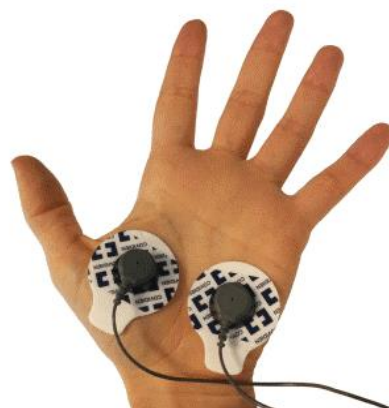
Kuva 2. Tutkimuksessa mitataan EEG:n lisäksi autonomisen hermoston reaktioita, jotka ilmentävät vireyttä. Kuvassa oikealla ihonsähköjohtavuuden mittaamisessa käytettävät elektrodit ja vasemmalla merkittynä kehoon paikat, joihin syke-elektrodit kiinnitetään.
